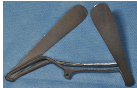
Şekil 3. Lazer sinterleme tekniği ile paslanmaz çelik tozlardan üretilen osteotomi aleti.
