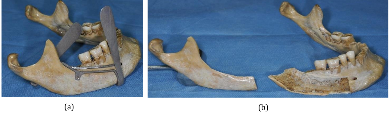
Şekil 4. Üretilen aletin, insan kadavra mandibulası üzerinde test edilmesi. (a) Aletin mandibula üzerine fikse edilmiş hali, (b) alet kullanılarak gerçekleştirilen osteotomi işlemi.
