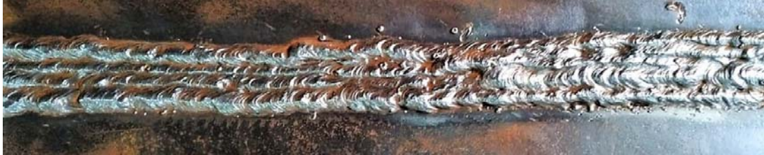
Şekil 3. Su altında kaynak edilen plakanın kaynak dikişi görüntüsü (The weld seam of plate welded underwater)
