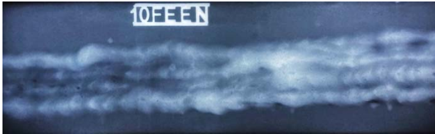
Şekil 4. Su altında kaynak edilen plakanın radyografik film görüntüsü (Radiographic film image of the plate welded underwater)
