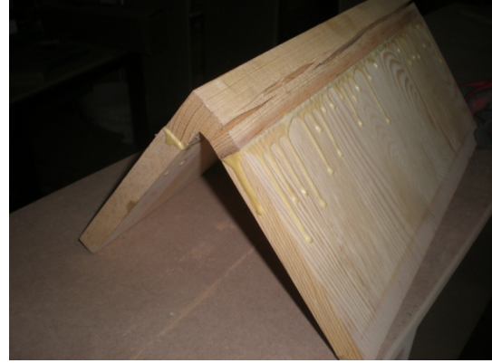
Şekil 4. L-köşe elemanlı deney örnekleri deney sonrası fotoğraflar
