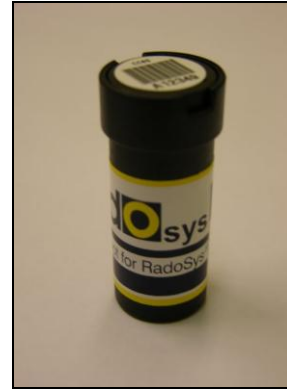
Şekil 1: Radon gazının ölçülmesinde kullanılan RSKS tipi CR-39 dedektörüne ait difüzyon kabı.
