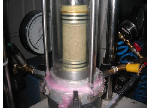
Şekil 11. Dinamik üç eksenli numunesinin doyurulma aşaması
