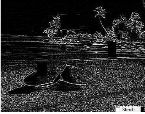
Şekil 13. Yatay kenar filtresi uygulanmış gauss görüntüsü
