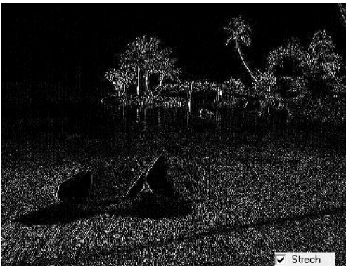
Şekil 9. Dikey kenar belirleme filtresi uygulanmış orijinal görüntü
