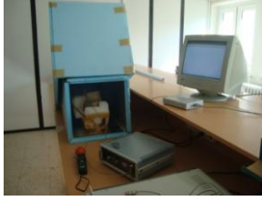
Şekil 1. Oluşturulan eşdeğer sıvı içerisinde sıcaklık artışı ölçümünün yapıldığı deney düzeneği
