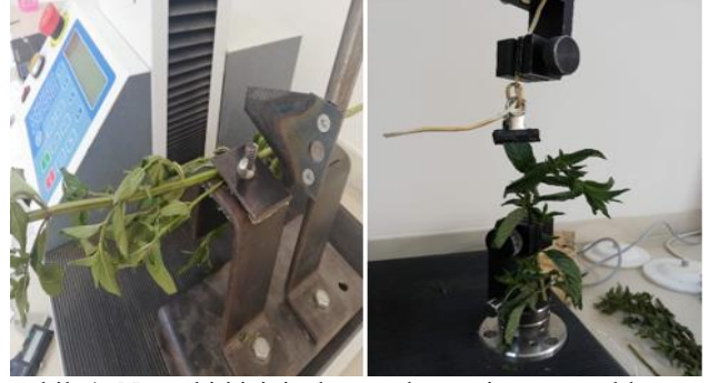
Şekil 4. Nane bitkisinin kesme kuvveti ve yapraklarının kopma kuvvetinin belirlenmesi Figure 4. Determination of cutting force of mint plant and breaking force of leaves
