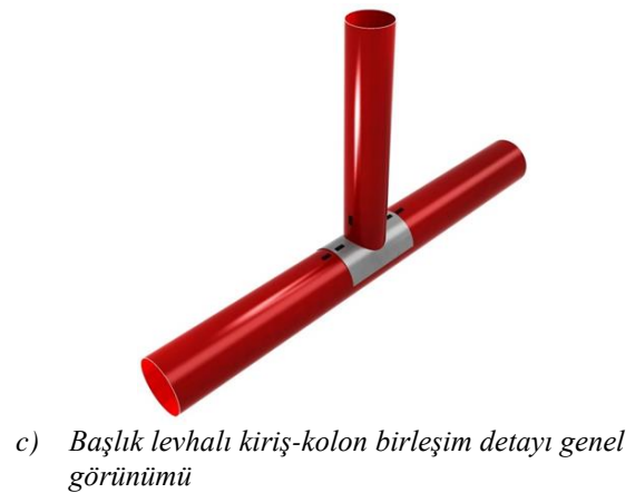
Şekil 2. Dairesel kesitli kiriş-kolon birleşimi başlık levhası
