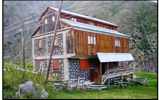
Fotoğraf 6. Taş Malzeme Kullanılarak İnşa Edilen ve Üzeri Ahşapla Kaplanan Yeni Mesken.
