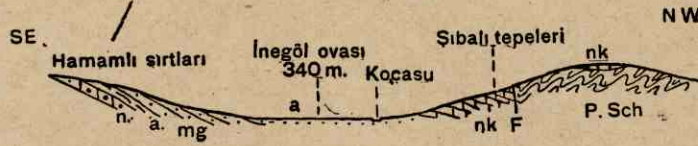
Şekil: 2 — Hamamlı sırtları ile Şıbalı tepelerinde Neojen'in durumunu gösteren kesit.
