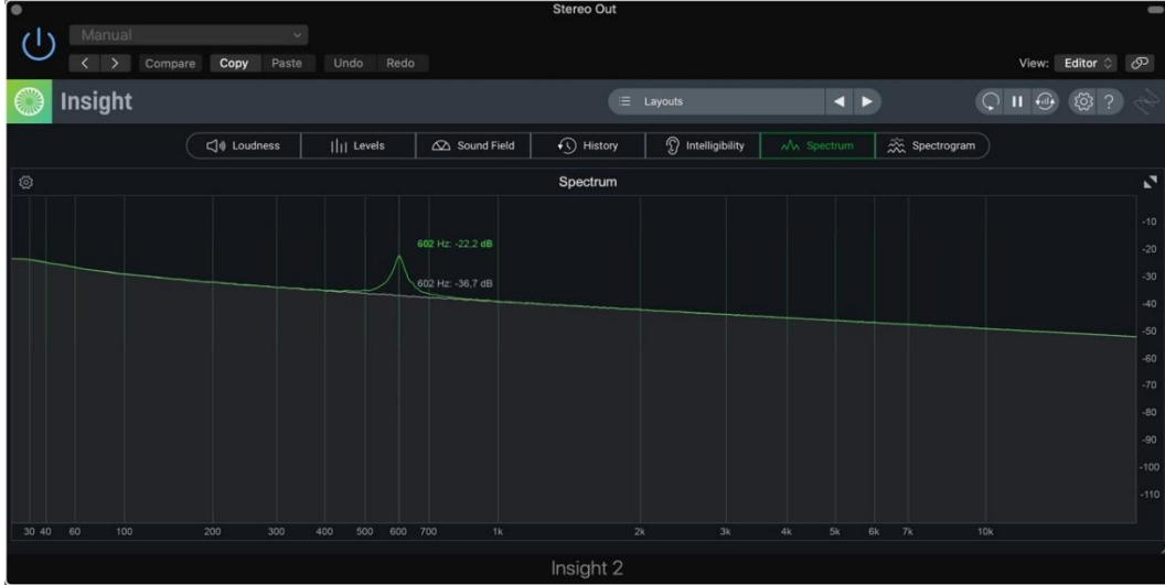
Resim 16. Waves F6 EQ Eklentisinde Yükseltilen 600 Hz Frekansının, Ses Sinyaline Olan Etkisi
