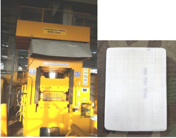
Şekil 11. Kompozit kumaşların üretiminde kullanılan hidrolik pres ve sert plaka haline gelen UHMWPE kumaş katmanları
