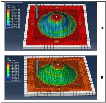
Fig. 3. Sheet thickness analysis. A) Experiment 6. B) Experiment 16.
