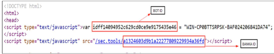
Şekil 10. Tarayıcıya enjekte edilen örnek bir kod parçası [30]
