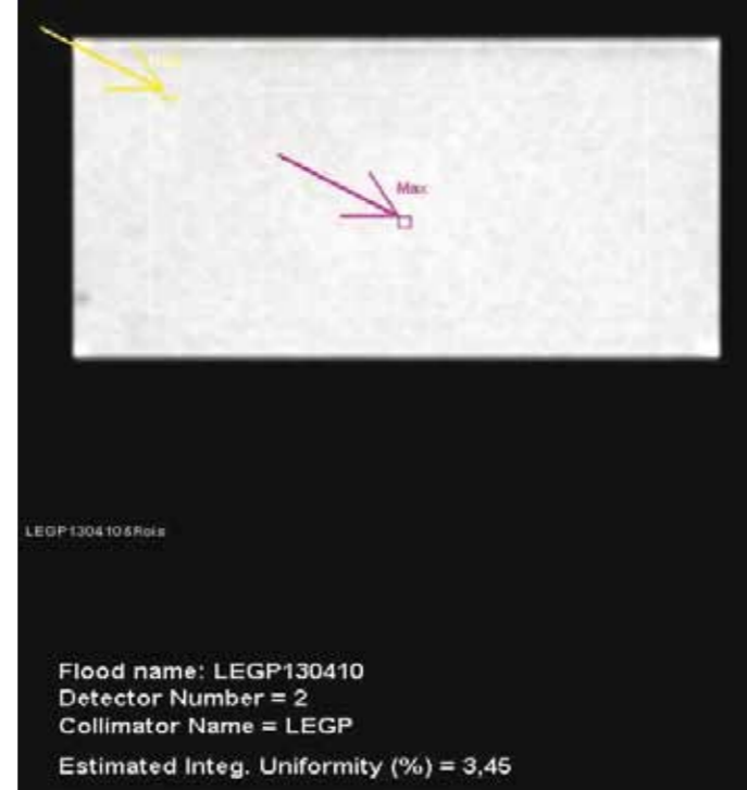
Resim 3- Homojenitenin sayısal olarak değerlendirilmesi. Düzlemsel kaynak ile alınan ekstrensek homojenite görüntüsünde kamera sisteminin yazılımı ile yapılan integral homojenite analizi sonucu gözlenmektedir. Görüntünün görsel ve sayısal olarak homojen olduğu izlenmektedir.
