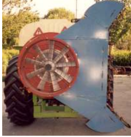
Şekil 1. Hava yönlendirme üniteli ilaçlama makinası. Figure 1. General view of the air-assisted sprayer with air deflector.
