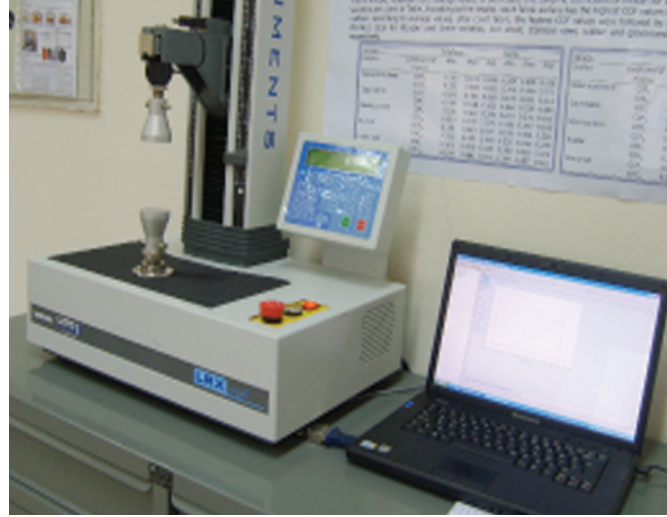
Şekil 2. Silindirik numune sıkıştırma test düzeneğinden bir görünüm
