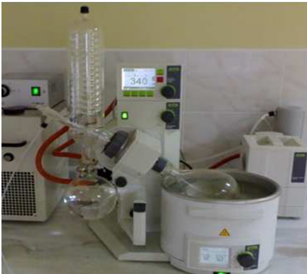
Şekil 2 Dönel vakum evaporatör (Rotavapor R-210)
