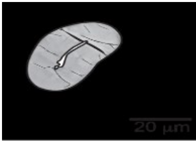
Şekil 14. Taranmış lifin kesit taramalı elektron mikroskobu görüntüsü.
