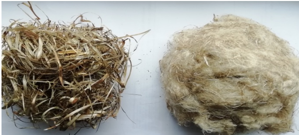
Şekil 1. Ham ve taranmış liflerin görüntüsü
