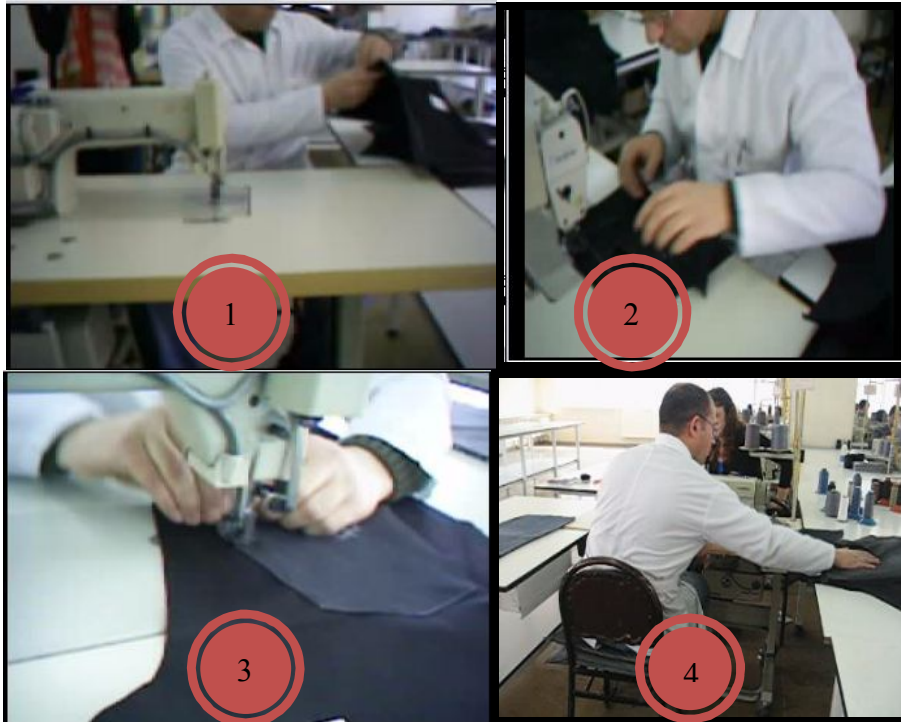
Şekil 7. Denim Pantolon Arka Cep Dikimi İş Akış Sırası
