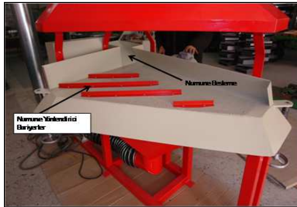
Şekil 3. Tabla Türü Havalı Zenginleştirici Deney Düzeneği Tabla Yüzeyi
