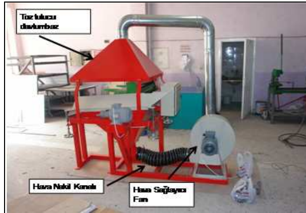
Şekil 2. Tabla Türü Havalı Zenginleştirici Deney Düzeneği Genel Görünüm
