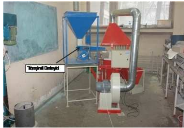
Şekil 5. Tabla Türü Havalı Zenginleştirici Deney Düzeneği Besleme Sistemi
