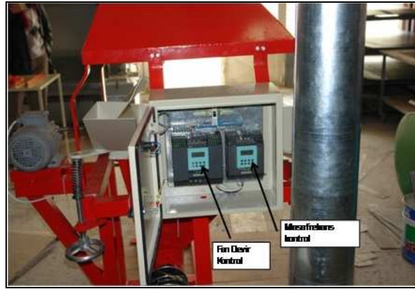
Şekil 4. Tabla Türü Havalı Zenginleştirici Deney Düzeneği Kontrol Sistemi
