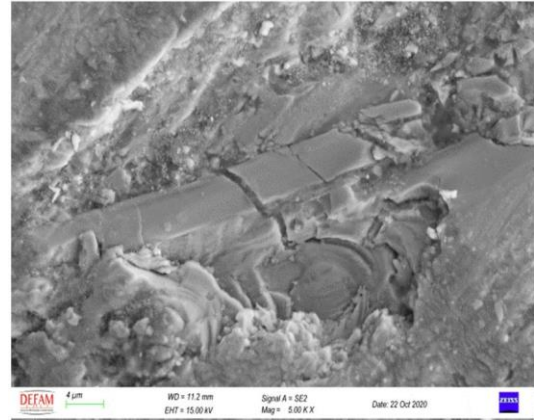
Şekil 11. 3FeMo-10FeV kaplamasında karbürlerin gevrek kırılması
