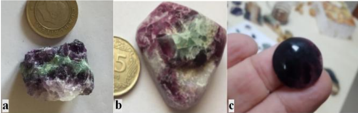
Şekil 13. İnceleme alanından alınan florit örneklerinin ham (a: işlenmemiş) ve süstaşı olarak işlenmiş (b:serbest kesim, c:yuvarlak kabaşon kesim) halleri.
