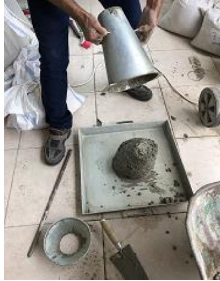
Şekil 4. Betonun karıştırılması ve çökme değerinin bulunması
