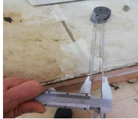
Şekil 3. a) Priz süresi tayini işlemi, b) Hacimsel genişleme işlemi
