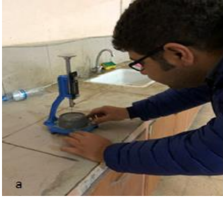
Şekil 3. a) Priz süresi tayini işlemi, b) Hacimsel genişleme işlemi
