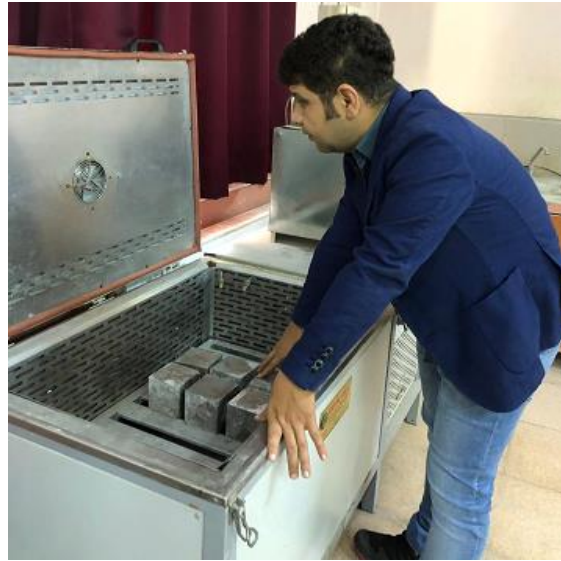
Şekil 8. Donma/çözülme test işlemi
