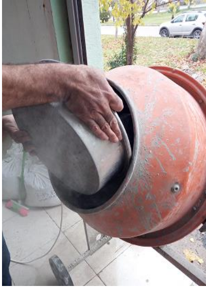
Şekil 4. Betonun karıştırılması ve çökme değerinin bulunması
