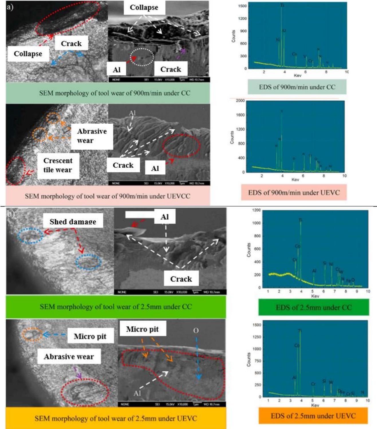
Figure 4. Tool wear in CC and UEVC, a) SEM and EDS tool wear images for 900 m/min and b) SEM and EDS tool wear images for  $a_p$  of 2.5 mm [23] (CC ve UEVC'de takım aşınması, a) 900 m/dak için SEM ve EDS takım aşınma görüntüleri ve b) 2,5 mm kesme derinliği için SEM ve EDS takım aşınma görüntüleri)
