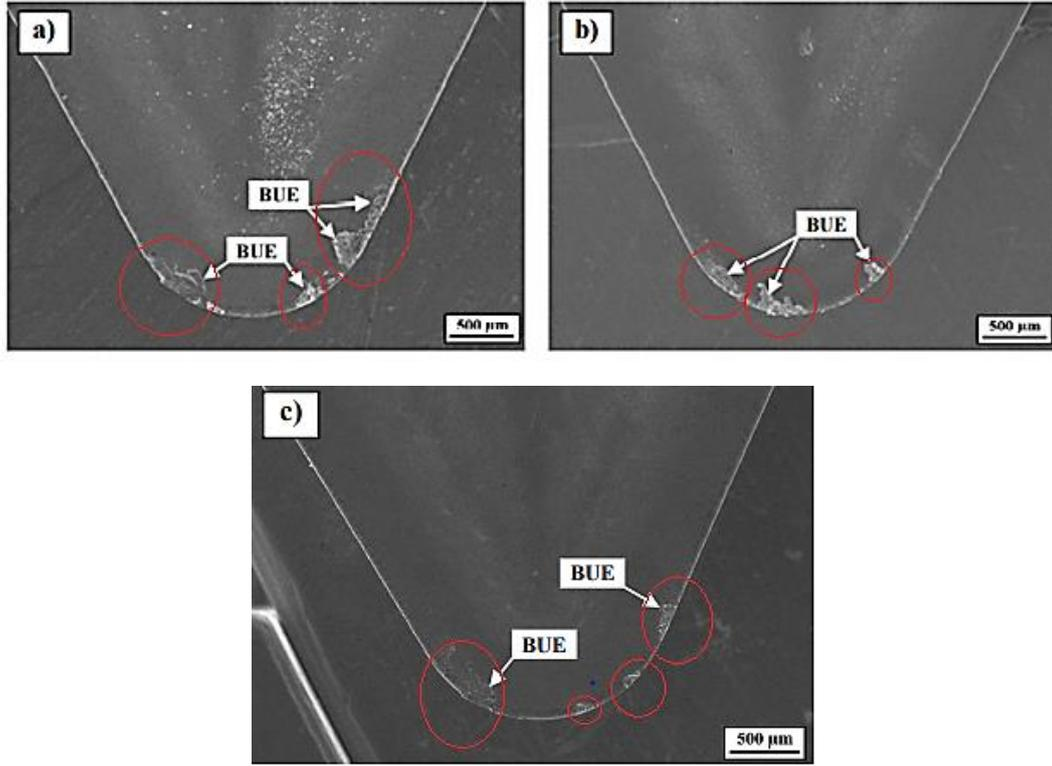
Figure 7. BUE formations at the different  $V_c$  values for Al-25Zn-3Cu alloy, a) 250 m/min, b) 350 m/min and c) 450 m/min [26] (Al-25Zn-3Cu alařımı için farklı kesme hızı deęerlerinde yıęıntı talař oluřumları)
