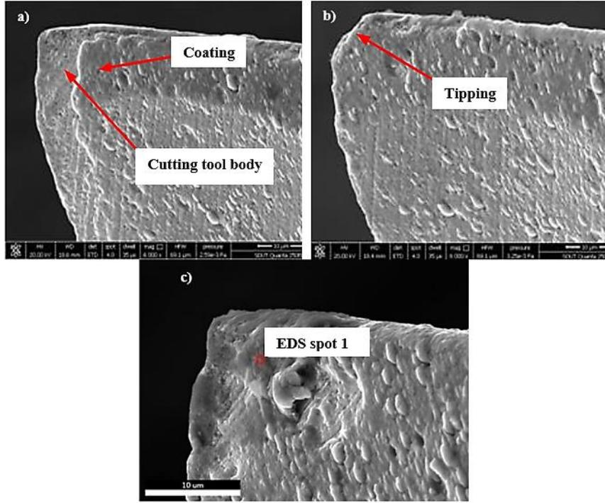
Figure 3. SEM (Scanning electron microscope) and EDS (Energy dispersive X-ray spectroscopy) images on TiAlN coated tool wear, a) Coating peeling, b) Breakage near edge nose of tool and c) Adhesive wear on tool [22] (TiAlN kaplamalı takımın takım aşınması görüntüleri, a) Kaplama soyulması, b) Takımın kenar ucuna yakın kırılma ve c) Takımda adhesiv aşınma)
