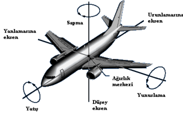
Şekil 2: Uçağın üç eksen etrafında yaptığı hareketler
