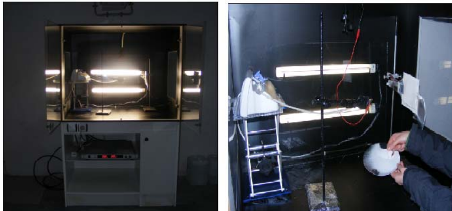
Şekil 2: Üretimler esnasında kullanılan elektro çekim düzeneği
