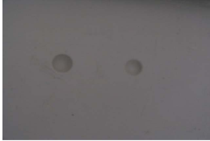
Şekil 9: Bilyenin şahit numune üzerinde oluşturduğu çukur
