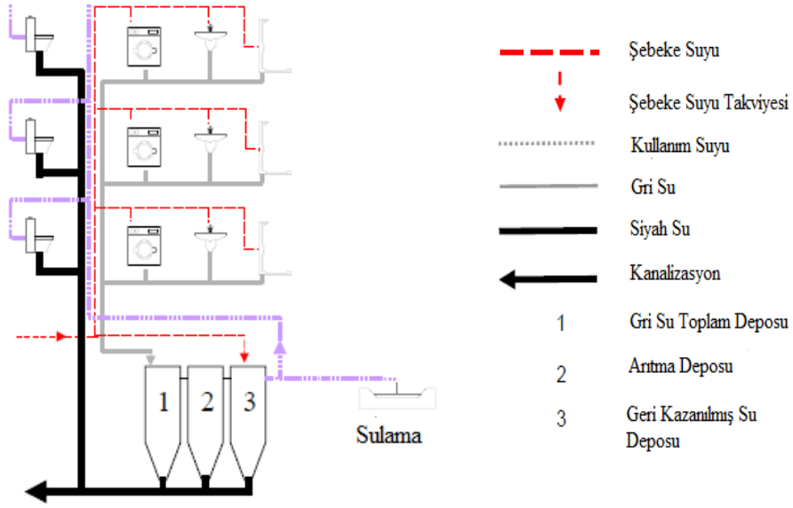
Şekil 9: Standart Gri Su Geri Kazanım Sisteminin Kurulum Şeması (Karahana, 2011)
