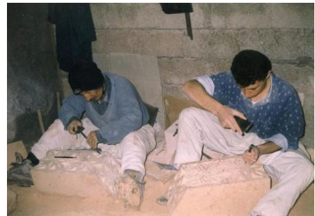
Şekil 4. Taş işlerken ince kalemlerle (demir) taşın işlenmesi (http://www.midyat.net).
