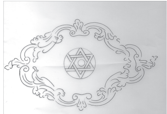
Resim 13: Beden Duvarlarının Üst Bölümünde Yer Alan Panoların Deseni (Barok yapraklardan oluşan madalyon ve altı köşeli yıldız formunda gülbezek, Ölçek :1/20 )
