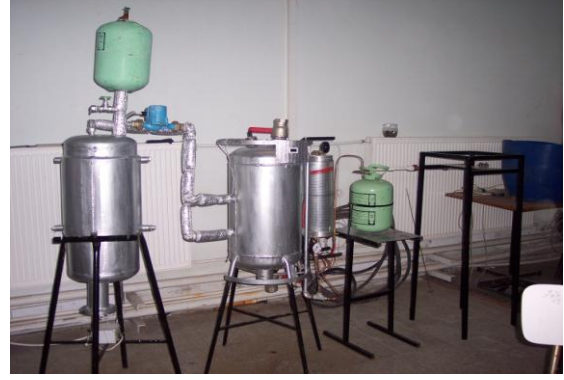
Şekil 2. Yekarum'daki laboratuvar ölçekli biyogaz ünitesi
