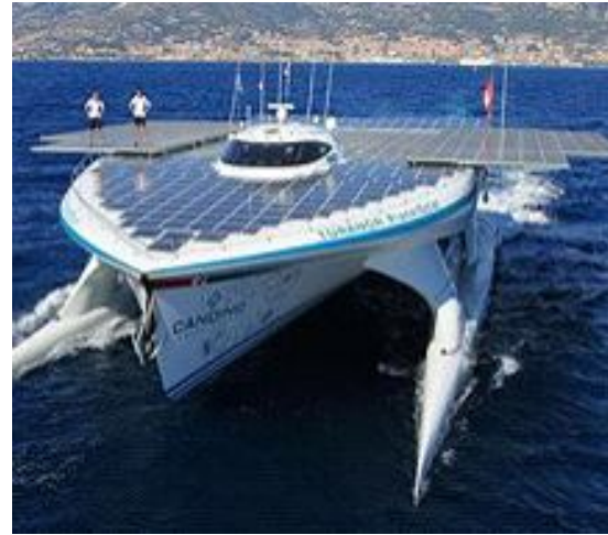
Şekil 15: Enerjisini tamamen güneş enerjisinden alan tekne uygulaması
