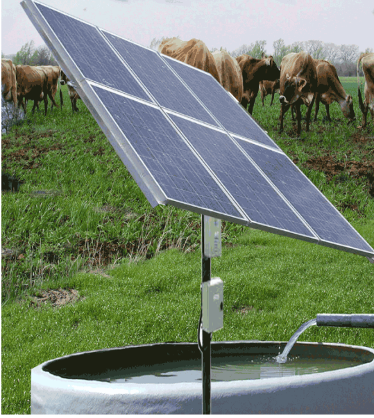
Şekil 12: Tarımsal sulamada elektrik enerjisi ihtiyacının güneş enerjisiyle sağlanmasına örnek
