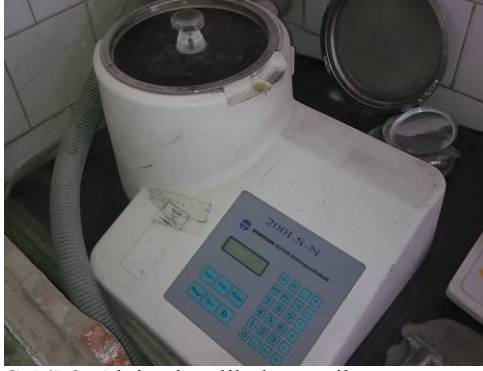
Şekil 3. Alpine incelik deney cihazı.
