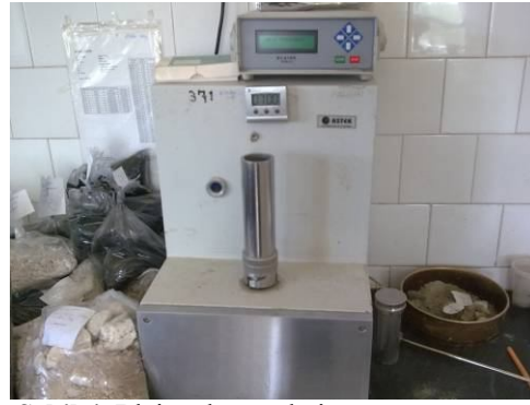
Şekil 4. Blaine deney aleti.
