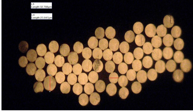
Şekil 2: L-Ro ipliğinin optik görüntüsü
