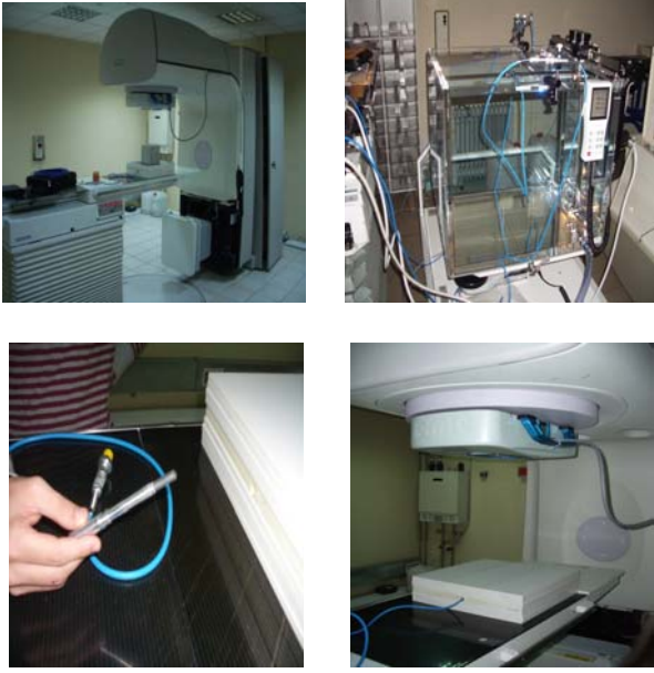
Şekil 2. Lineer hızlandırıcı Kalibrasyon için kullanılan su fantomu, İyon odası
