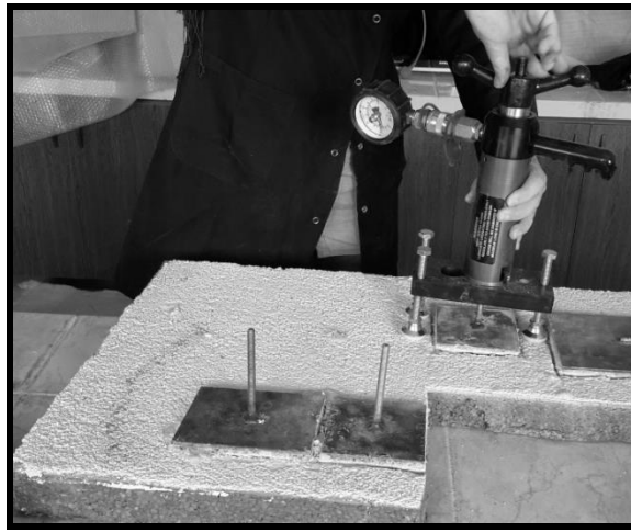
řekil 5. Mantolama levhalarına yapıřma testi iin levha yapıřtırılması ve pull-off testi
