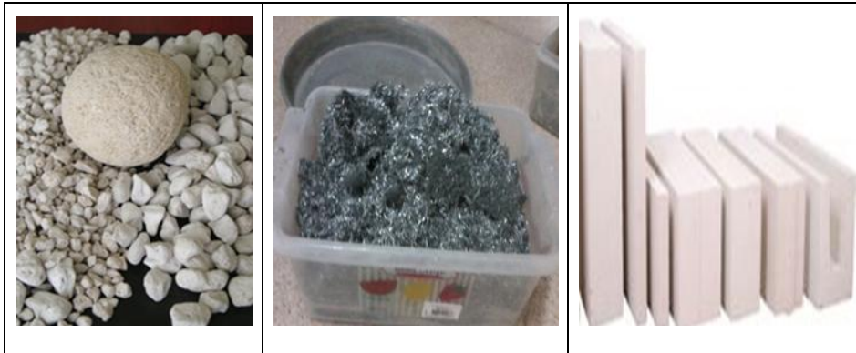
Şekil 1. Çalışmada kullanılan bims agregaları, alüminyum talaşı ve gazbeton
