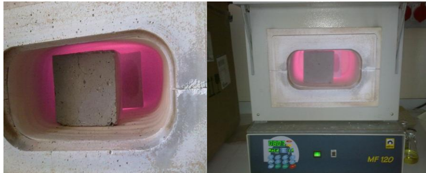
Şekil 2. Kül fırını içerisinde yüksek sıcaklığa maruz kalan numuneler
