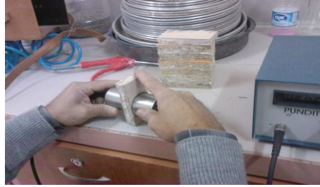
Şekil 6. Numunelerin Ses Geçirgenliğinin Bulunması
