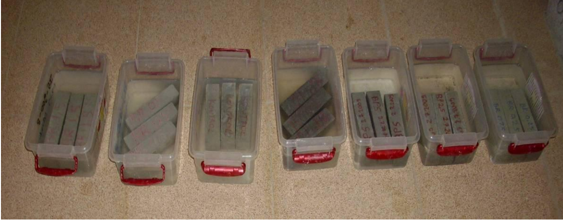
Şekil 4. 360 Gün %5 Na 2 SO 4 Çözeltisinde bekletilen harç numuneleri
