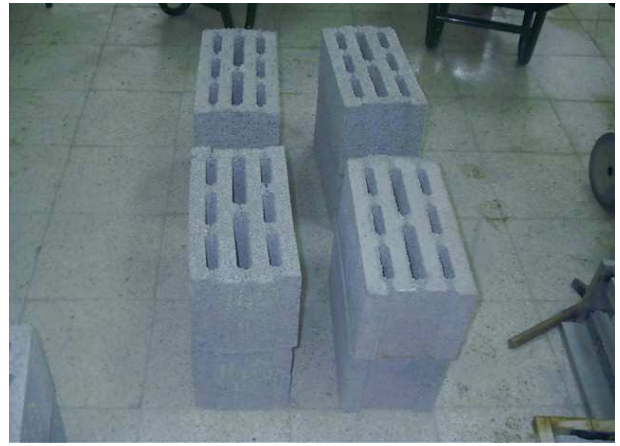
Şekil 5. Üç sıra boşluklu blok
