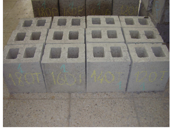
Şekil 3. Tek sıra boşluklu blok
