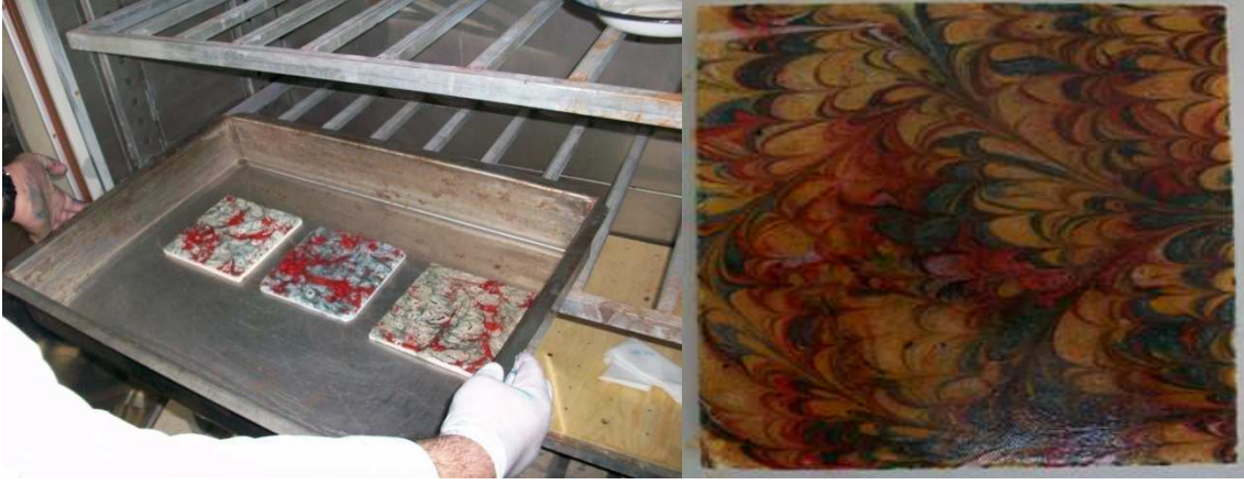
Şekil 3. Ebru motifli mermerin etüvde kurutulması. Yüzeyi verniklenmiş mermer (ham yüzey). (Şen, 2009).
