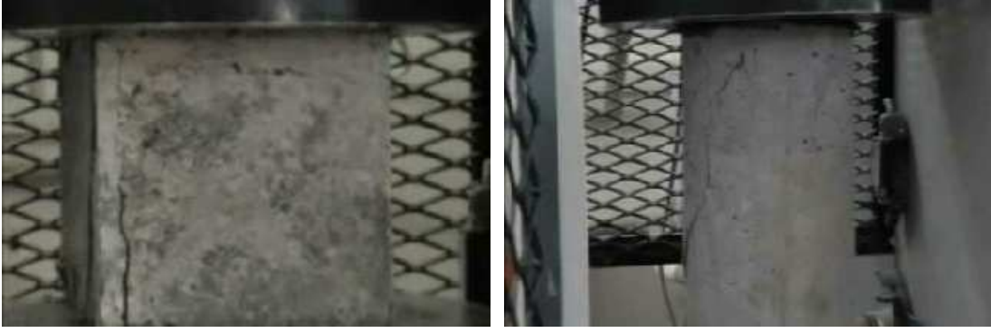
Şekil 1. Küp ve silindir numunelerin deney sonrası kırılma şekilleri [4]
