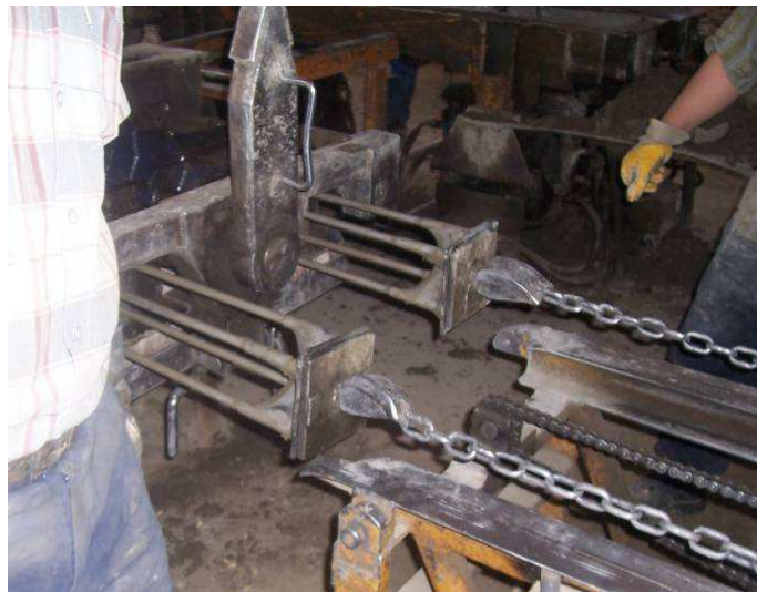
Őekil 3. Maça çubuklarının çıkarılması
