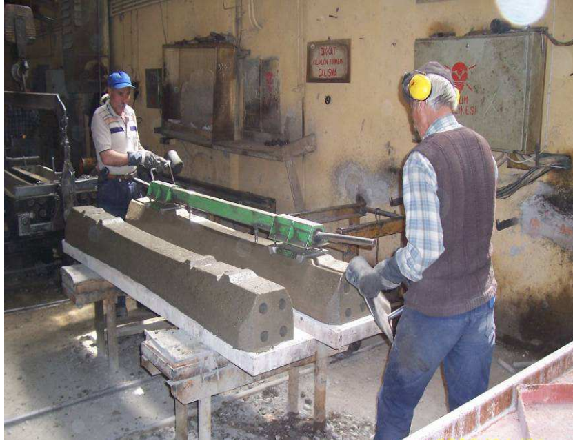
Őekil 4. Traversin ray yuvasının masterla kontrol edilmesi
