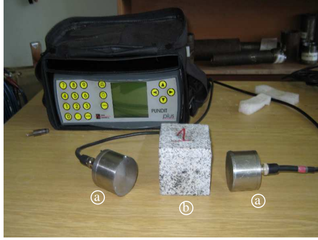
Şekil 11. Ultrasonik hız deneyinin yapılışı, a) prop, b) 7 x 7 x 7 cm numune.
