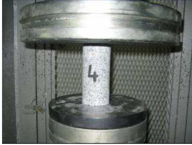
Şekil 3. Tek eksenli basınç deneyinin yapılışı.
