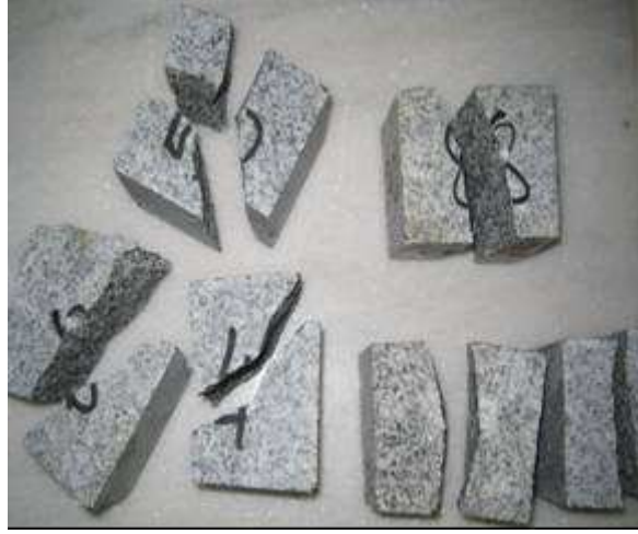
Őekil 4. Nokta y¼k dayanımı sonucu ¼rneklerin kırılma Őekilleri
