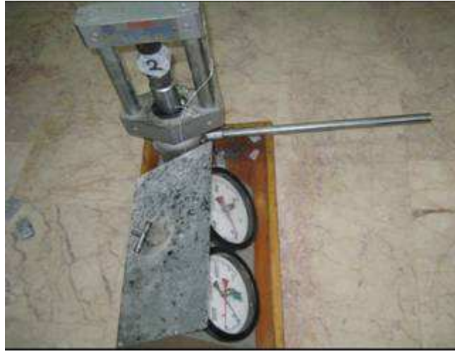
Őekil 5. Yarmada ¼ekme deneyinin yapılıŐı
