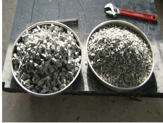
Şekil 10. Los Angeles aşınma deney numuneleri
