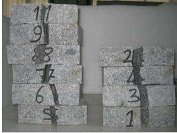
Şekil 7. Eğilme dayanımı numunelerinin kırılış şekilleri
