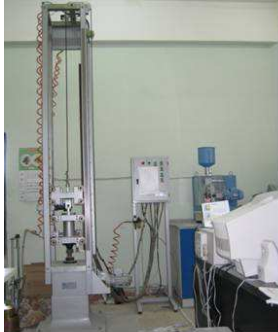
Şekil 8. Darbe dayanımı deney düzeneği
