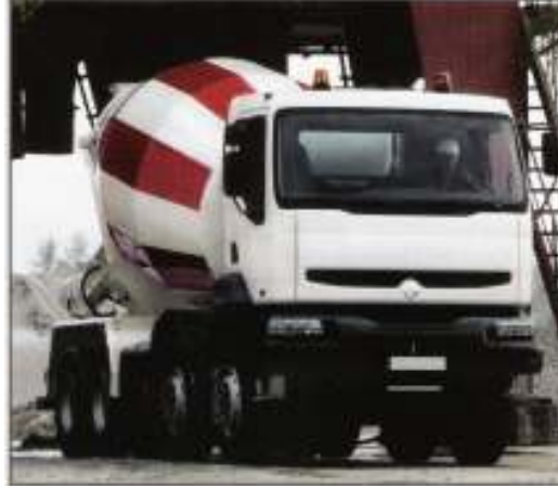
Şekil 5. Transmikser İle Hazır Betonun Taşınması
