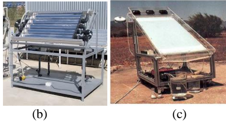
Şekil 1. (a): Fotokataliz prosesi mekanizması, TiO_2 örneği kavramsal diyagramı, (b): Askıda sistem fotokataliz düzeneği örneği, (c): İnce-film fotokataliz sistemi, Plataforma Solar de Almeria [35,36]
