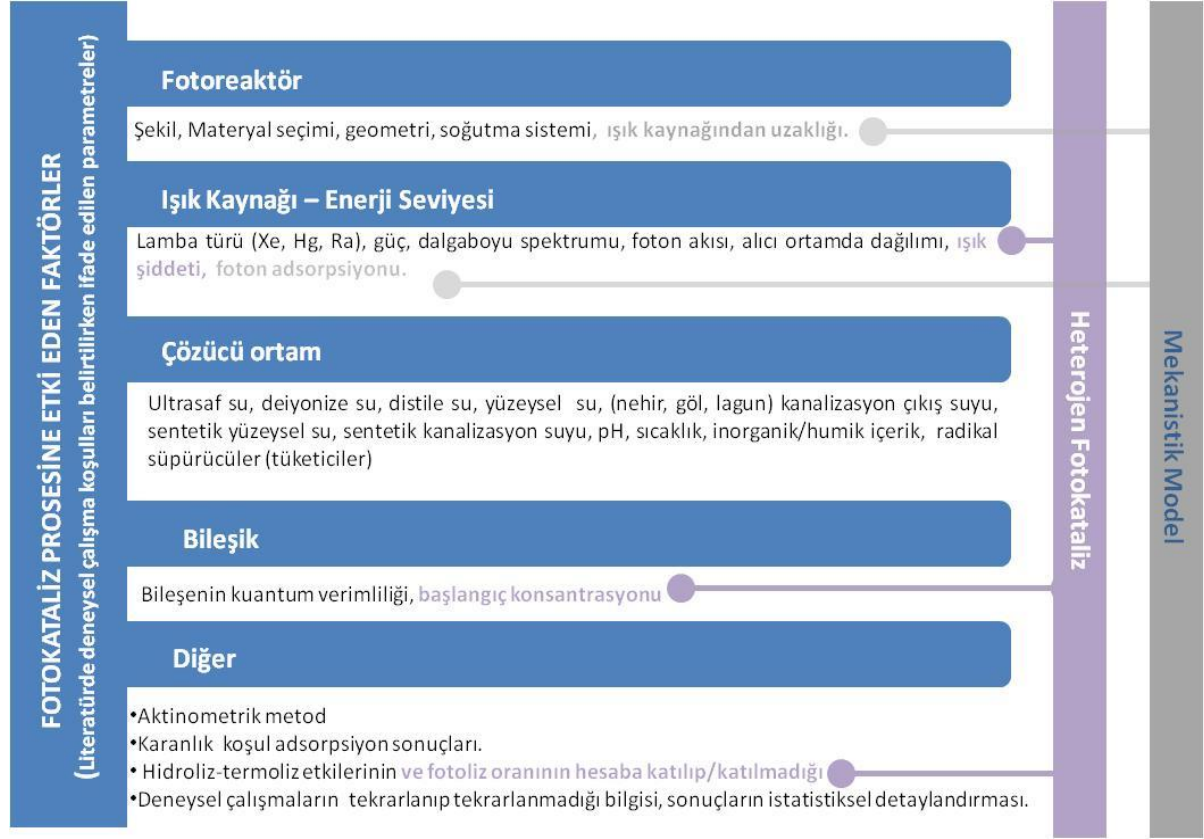
Şekil 2. Fotokataliz prosesi mekanizmasında etkin parametreler ve yaklaşımlar [58]
