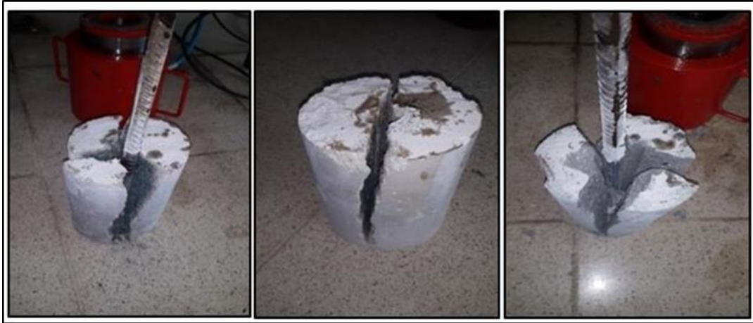
Şekil 15. Numunelerin çekip çıkarma deneyinde kırılma şekli
