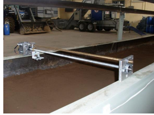
Şekil 3. Ultrasonik sensörün bağlandığı vidalı mil düzenegi.
