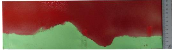
b) Sac levha kullanılarak elde edilen bozulmamış çizi profili b) undisturp furrow profile obtained using sheet metal.
