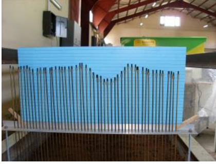
c) Profilmetre kullanılarak elde edilen çizi profili. c) Furrow profile obtained using profilometre.
