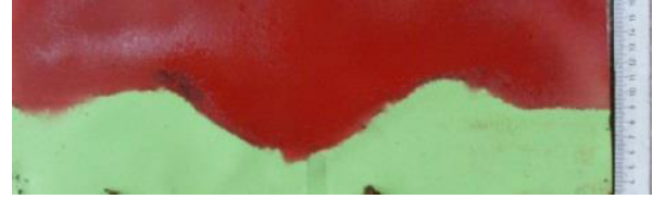
a) Sac levha kullanılarak elde edilen bozulmamış çizgi profili b) Undisturp furrow profile obtained using sheet metal.
