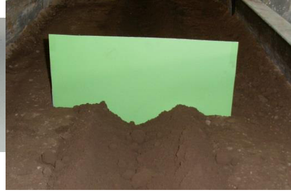
Şekil 8. Üzerine kâğıt yapıştırılan sac levhanın çiziye batırılmış durumu.
